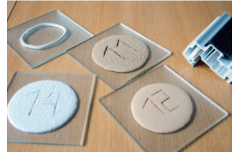
Die vorgesehenen Baustoffe werden vorgängig auf ihre Verträglichkeit getestet.
